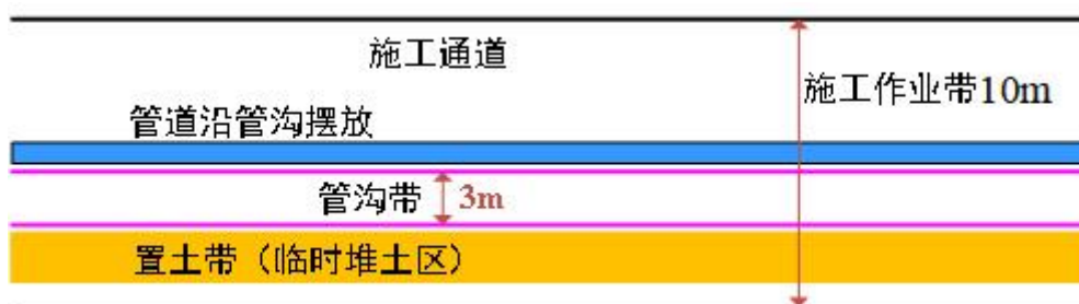
图 3.4-4 一般地段管道大开挖施工断面布置图
